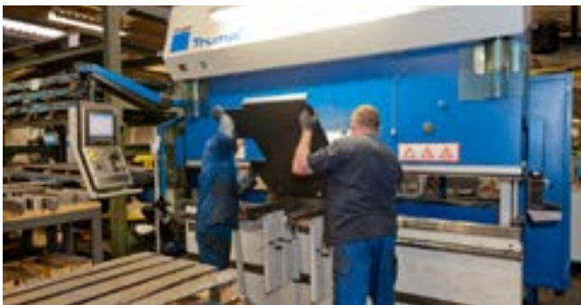
Computerunterstütztes Biegen von Stahlplatten
