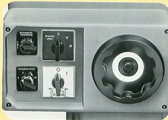
Sowohl beim Dickenhobeln als auch beim Abrichten sind die Bedienschalter bequem zu betätigen. Die elektrische Dickentischverstellung mit zusätzlicher Handradfeineinstellung und die Digitalanzeige für die Hobelhöhe erlauben eine Einstellgenauigkeit von 0,1 mm.
