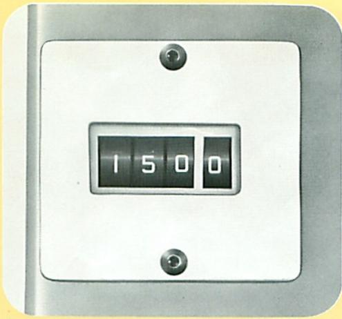
Die Anzeige für die Hobelhöhe befindet sich oben in der Deckelhaube. Die großen Ziffern sind gut ablesbar. Die Einstellgenauigkeit beträgt 0,1 mm.
