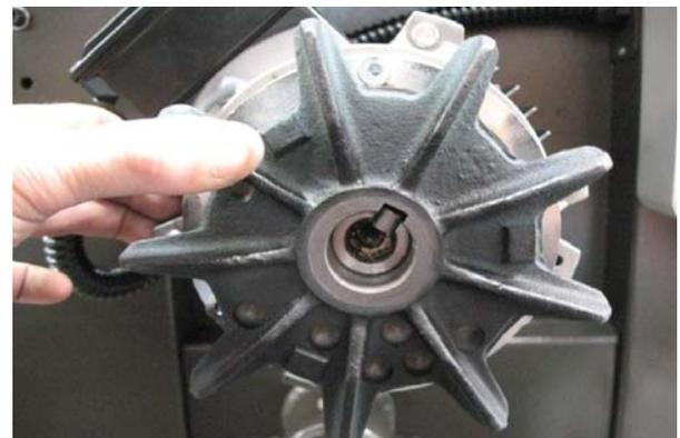
Abb. 27: Lüfterrad auf Welle setzen
