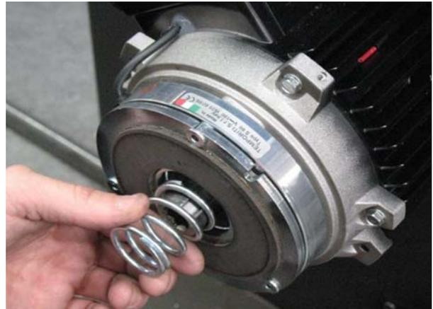
Abb. 25: Feder einsetzen
