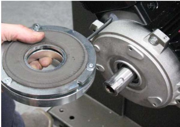
Abb. 23: Bremsspule (links)
