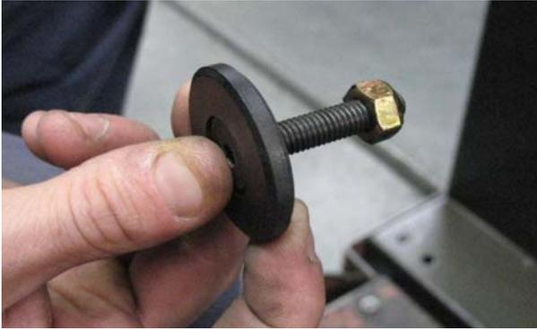
Abb. 28: Befestigungsschraube vorbereiten
