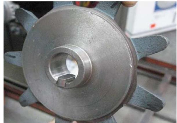
Abb. 26: Passfeder in Nut einsetzen
