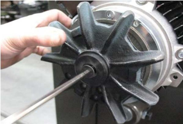
Abb. 29: Lüfterrad befestigen
