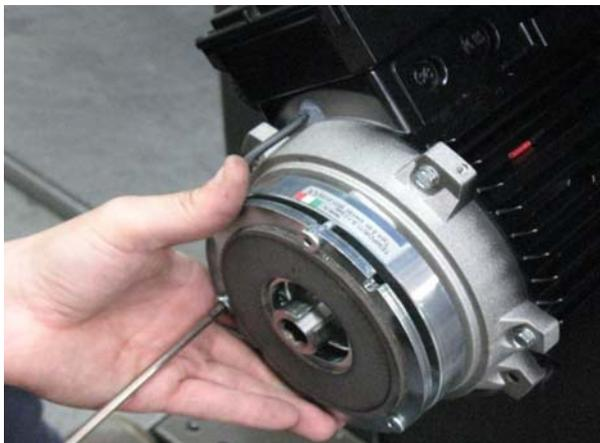
Abb. 24: Bremsspule fixieren
