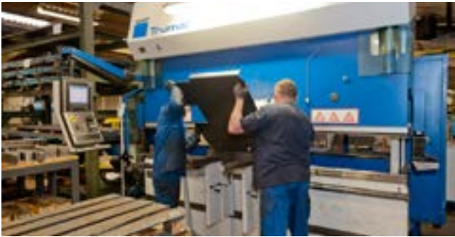
Computerunterstütztes Biegen von Stahlplatten
