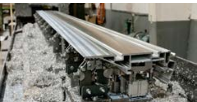
Fräsen der Schiebetischfläche
