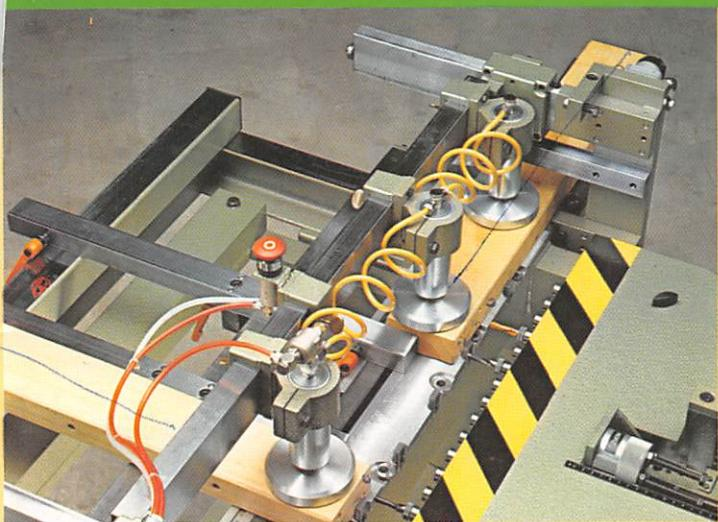
Zum Rahmendübeln werden die Querfriese an den Seitenanschlägen wechselseitig angelegt. Die Längsfriese sind an Klappanschlägen 312/6107/R zu bohren, die auf gleiche Position wie die Seitenanschläge zu bringen sind.
