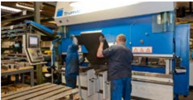
Computerunterstütztes Biegen von Stahlplatten
