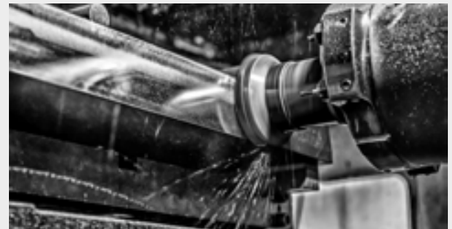
Kantenfräsen von Gusseisentischen
