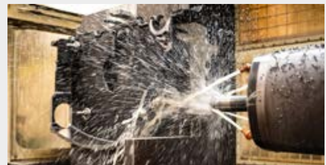
CNC Bearbeitung von gusseisernen Sägeaggregaten
