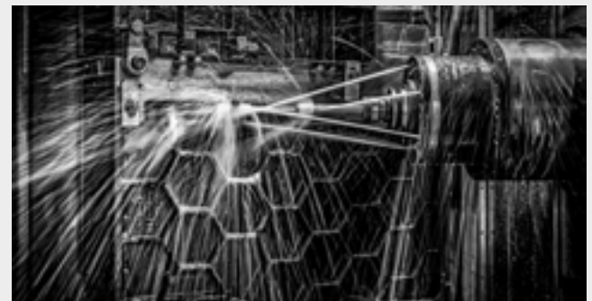
CNC-Bearbeitung von Gusseisentischen
