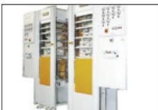
**Joos Formteil-Pressen** werden entsprechend den individuellen Anforderungen als Ober- oder als Unterkolbenpressen gefertigt. Das Beispiel zeigt zwei spiegelbildlich gefertigte Formteilpressen zur Herstellung von Stuhlsitzen und Rückenlehnen in mehreren Etagen.
