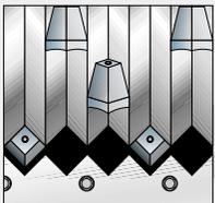
Profilrotor mit in den Tälern eingesetzten Schneidmessern
