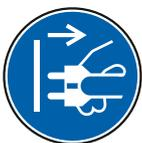
**Trennen Sie bei Wartungs-, Rüst- oder Reinigungsarbeiten die Maschine vom Netzstecker.** Versichern Sie sich, dass sich der Ein-/Ausschalter in der „OFF“ Position befindet, bevor Sie die Maschine wieder an den Stromkreislauf anschließen. Wenn das Gerät nicht mehr benutzt wird ziehen Sie den Netzstecker.
