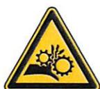
**Warnung! Rotierende Teile.** Achten Sie darauf, dass Sie unter keinen Umständen in die rotierenden Werkstücke oder Maschinenteile greifen und passen Sie auf, dass Schmuck und Kleidungsstücke nicht von drehenden Teilen erfasst werden können. Es besteht erhebliche Verletzungsgefahr!
