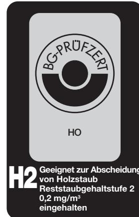
des Hauptverbandes der gewerblichen Berufsgenossenschaften e.V., Alte Heerstr. 111, 53757 St. Augustin, Fachausschuß „HOLZ“ von der Prüfstelle des Fachausschusses „HOLZ“, Kalscheurer Weg 12, 50969 Köln geprüft. Er ist damit geeignet zur Abscheidung von Holzstaub, wobei die Reststaubgehaltstufe 2 „H2“, 0,2 mg/m<sup>3</sup> sicher eingehalten wird. Er trägt das GS-Zeichen mit dem entsprechenden Zusatz:
