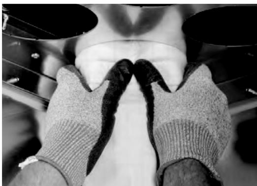
Filterbund soweit einknicken, bis sich der Filter nach unten entnehmen lässt
