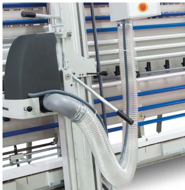
Abb. 19: Absaugschlauch montieren
