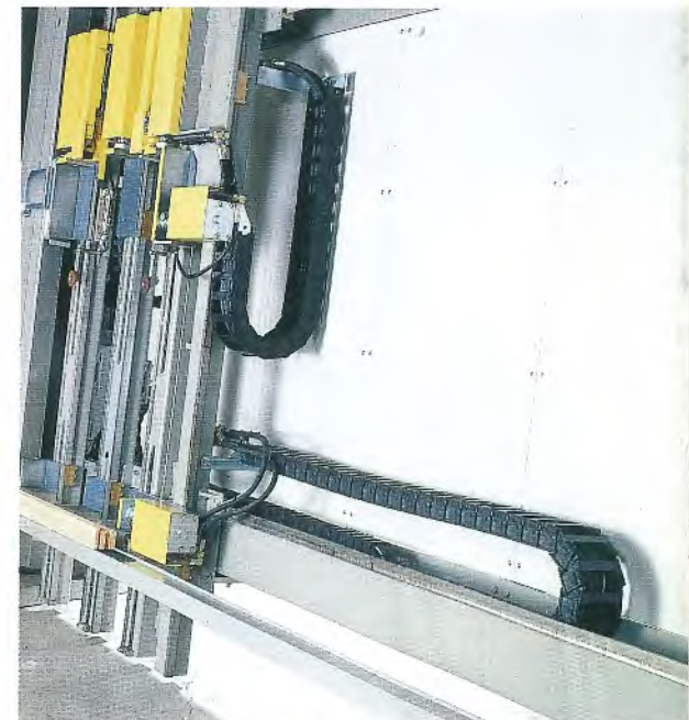
Hochleistungstechnik im Zeichen der Arbeitssicherheit: Energieführungskette mit exakt und knicksicher zusammengefaßten Hydraulikschläuchen und Kabeln.
