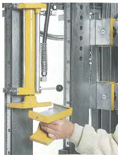
Für die Schrägensterverleimung lassen sich Pendeldruckplatten (Zubehör) einfach und blitzschnell aufsetzen.
