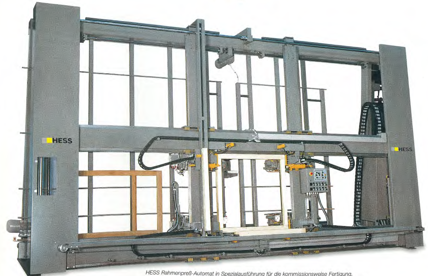
HESS Rahmenpreß-Automat in Spezialausführung für die kommissionsweise Fertigung. Maßabfrage und zentrische Maßeinstellung (halbe Wege, halbe Zeit) über Opto-Elektronik. Alle übrigen Funktionen wie Preßablauf, Bohren der Ecklager (auf allen 4 Preßbecken aufgebaute Bohreinrichtungen), Rahmenaus- und -Weitertransport sind automatisiert und taktgesteuert.
