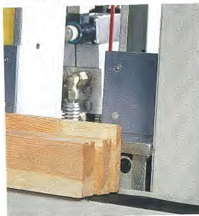
Die Opto-Elektronik: Während des Preßvorgangs können die Rahmenteile des nächsten Fensters beleimt und vorgelegt werden. Die Breitenmaßeinstellung erfolgt dann automatisch.
