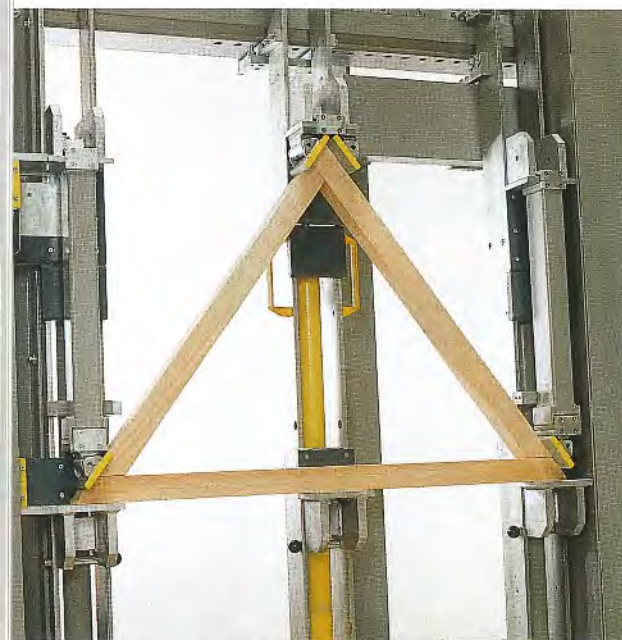
Mit der entsprechenden Steuerung und Pendeldruckplatten (Zubehör) lassen sich auch extrem spitzwinklige Schrägfenster ohne lange Rüstzeiten pressen.
