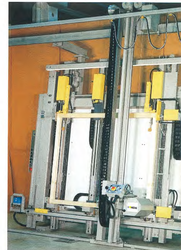
Besonders vorteilhaft bei der Montage großer, schwerer Elemente: die überfahrbare Einbohrnrichtung für Ecklager (Zusatzrüstung)
