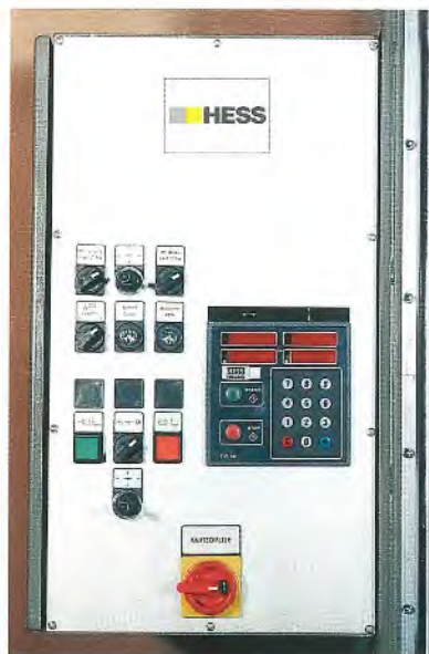
HESS Centro Digital Maßvorgabe über Tastatur nach der Zuschnittsliste während eines ablaufenden Preßvorgangs; automatische Verstellung auf das neue Arbeitsmaß durch Entnahme des verleimten Werkstücks.
