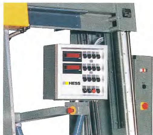
HESS Centro Leser: Externe Maßvorgabe aus dem computergesteuerten Fertigungsablauf (Vormaschine, Zentral-Computer o.ä.) schon während eines ablaufenden Preßvorgangs. Durch Entnahme automatische Verstellung auf das neue Arbeitsmaß.
