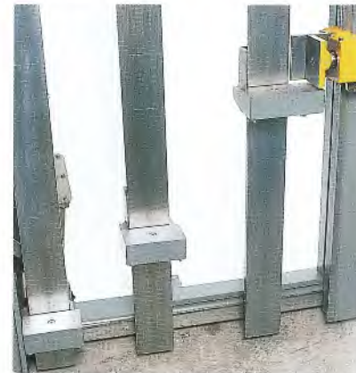
Die vertikalen Widerlager können in drei Positionen auf die jeweils günstigste Einlegehöhe positioniert werden.
