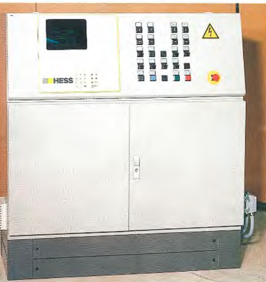
HESS Centro Leser: Externe Maßvorgabe aus dem computergesteuerten Fertigungsablauf (Vormaschine, Zentral-Computer o.ä.) schon während eines ablaufenden Preßvorgangs. Durch Entnahme automatische Verstellung auf das neue Arbeitsmaß.
