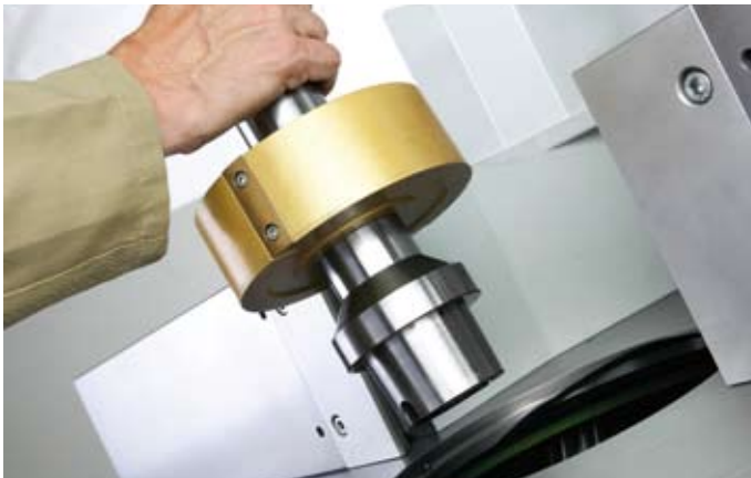
Fräsdorn-Schnellwechselsystem HSK, mit automatischer elektromechanischer Spindelarrretierung
