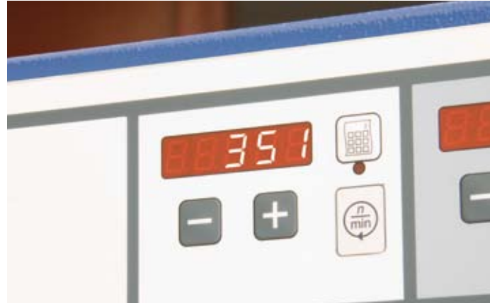
stufenlose Drehzahlverstellung 1500 - 10000 u/min
