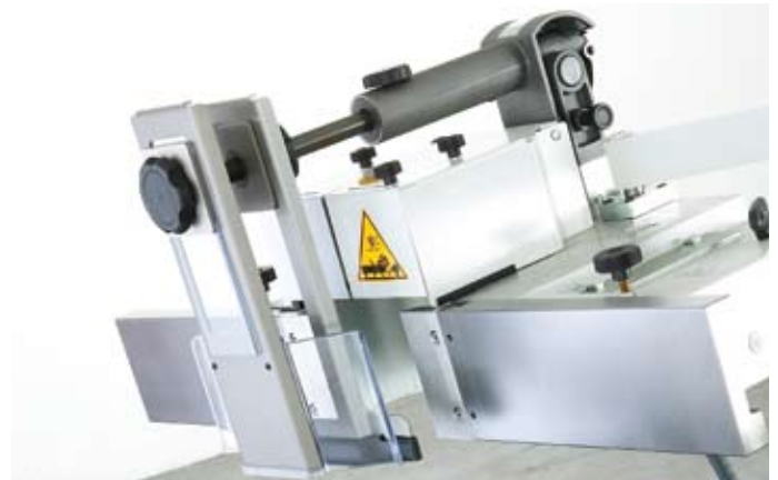
Robuster Fräsansschlagkörper Typ 204 mit elektromotorischer Fixierung
