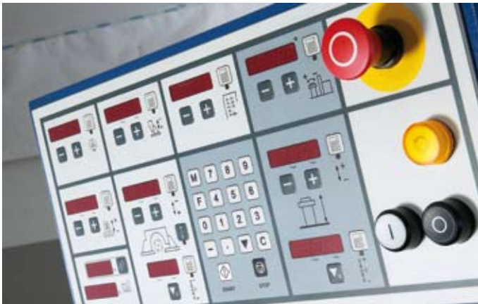
4-Achs-Positioniersteuerung für Höhen- und Schwenkverstellung, incl. Verstellung des Gesamt- und Teilanschlages
