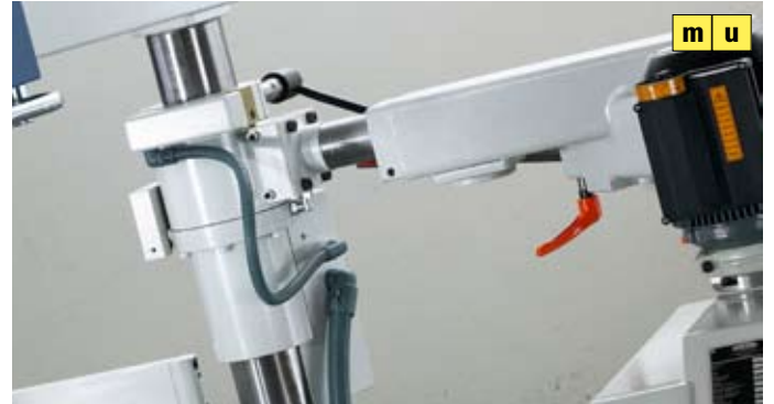
Comfort-Vorschub-Tragarm, elektromotorisch höhenverstellbar, Positionierung über Achsenmodul
