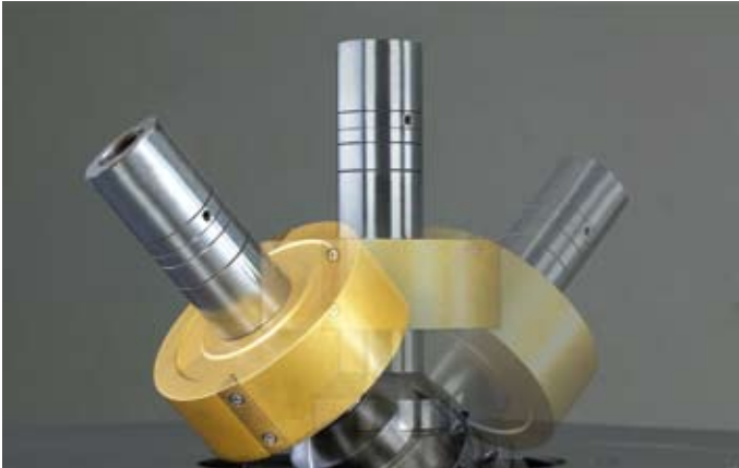
Beidseitiger Schwenkbereich + 45,5 bis - 45,5°
