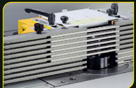
Integral fence AIGNER Fräsenchutz Integralanschlag AIGNER
