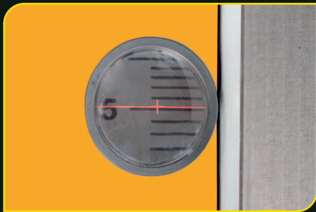
Stock removal indication Anzeige für Spanabnahme
