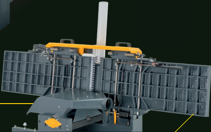
Parallel hinged planing tables Parallelaufklappbare Abrichttische
