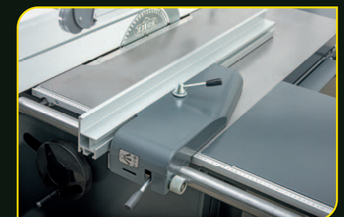
Rip fence with fine tuning Feineinstellung für Längsanschlag
