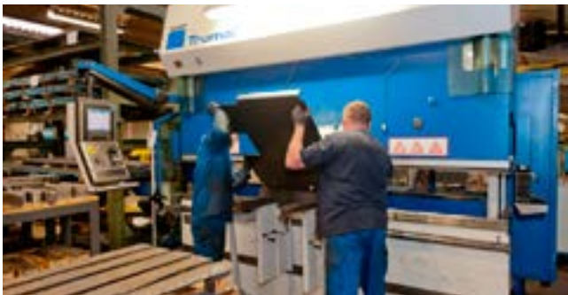
Computerunterstütztes Biegen von Stahlplatten
