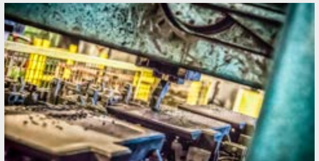
Oberflächenabkratzen des Gusseisentisches
