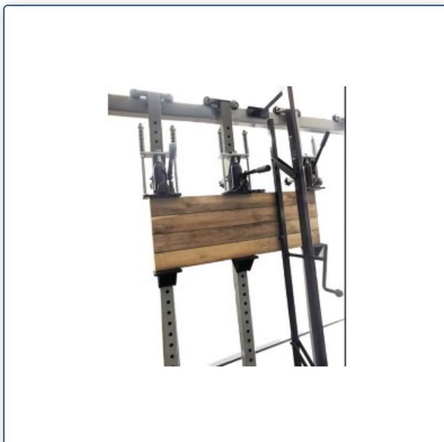
Integrierter Niederhalter presst das Werkstück an die vertikalen Profile und verhindert ein Durchbiegen des Werkstücks
